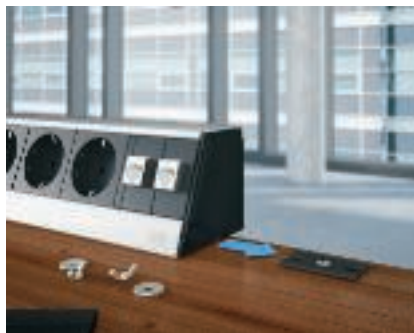
Монтаж настольного бокса с помощью комплекта для крепления Настольный бокс устанавливается на крепежный элемент с боковой стороны. Для этого сначала необходимо снять торцевую заглушку.
